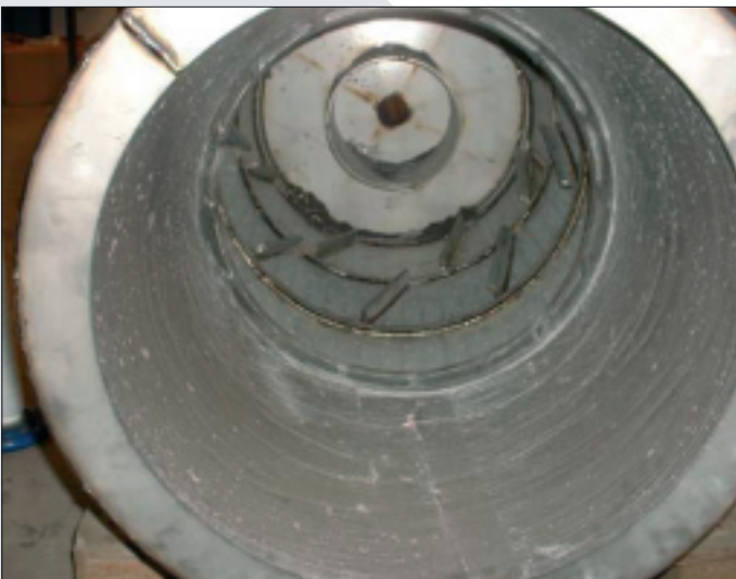
Bild 8. Brennkammer mit Keramikauskleidung
